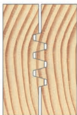
I-GIUNZIONE FORZATA GB-FORCED JOINTING D-ANGEZOGENE VERBINDUNG E-UNION FORZADA F-ASSEMBLAGE SERRÉ
